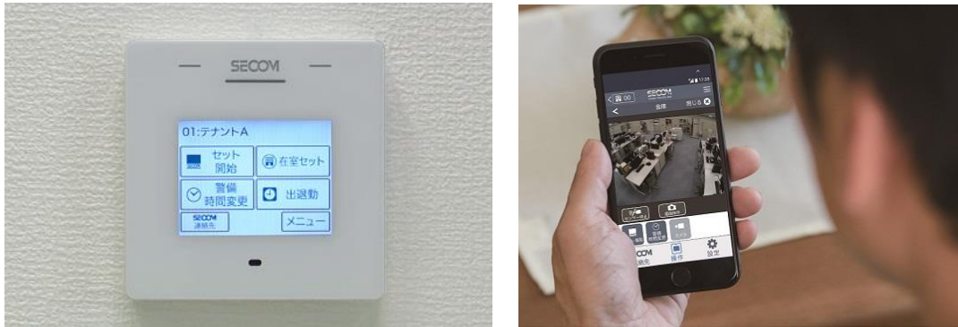
システムセキュリティ「AZ」の操作表示器（左）とスマートフォンでの映像確認機能（右）
