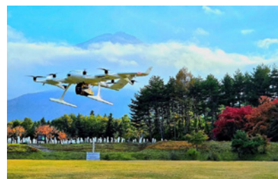
ドイツ Wingcopter GmbH 製の高性能eVTOL型固定翼ドローンにイエロースキャン製 UAV 搭載型スキャナー「Voyager」を搭載 写真提供：伊藤忠商事（株）
