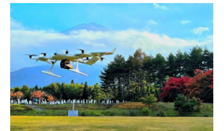
ドイツ Wingcopter GmbH 製の高性能eVTOL型固定翼ドローンにイエロースキャン製 UAV 搭載型スキャナー「Voyager」を搭載 写真提供：伊藤忠商事（株）
