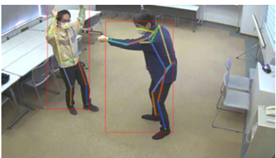
「セコムAI行動検知システム」で検出する動きの一例（脅迫）
