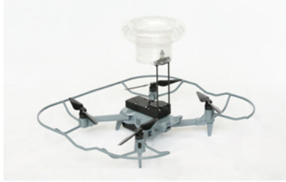
ドローン加煙試験器（能美防災）
