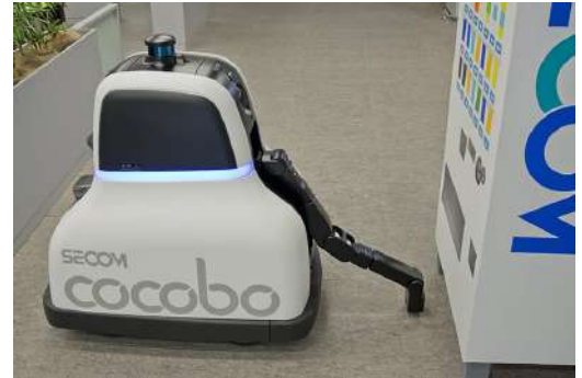
装着したアームで点検業務を行う「cocobo」
