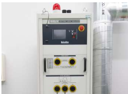
雷サージに対する耐性を試験する装置
