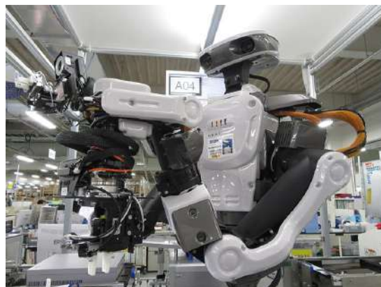
24時間無人で製品の検査工程を担うロボット
