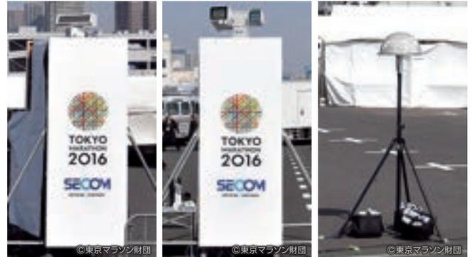
不審なドローンの早期発見・対処を支援した「セコム・ドローン検知システム」
