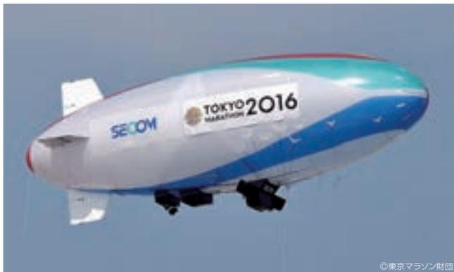
民間防犯用として世界初の実用化となった係留型「セコム飛行船」
