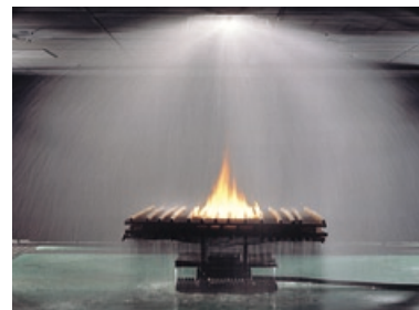
スプリンクラー消火実験
