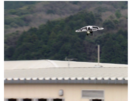
事前に設定した経路で敷地内を自律飛行し巡回監視する「セコムドローン」
