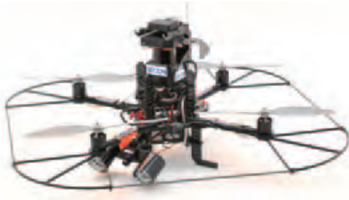
セコムの技術を活用した自律型の 小型飛行監視ロボット
