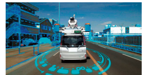
路上空間3次元座標データ計測システム「Real Dimension」
