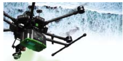
ドローン搭載型グリーンレーザースキャナ
