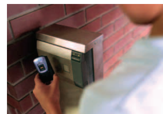
ICタグと「ココセコム」を融合させた「ココセコム登下校管理システム」
